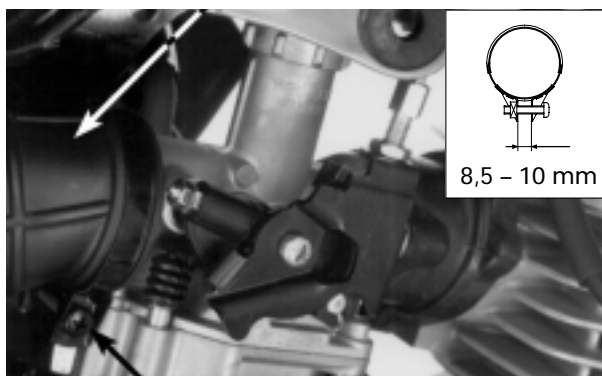
PARAFUSO DA BRAÇADEIRA DO TUBO DE CONEXÃO
